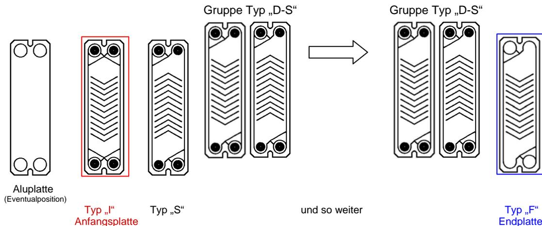
Aluplatten werden nicht bei allen Modellen verwendet (Eventualposition), das Pressmass ist entsprechend anzupassen!
